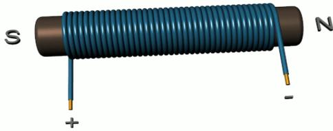
والشكل المقابل يوضح تركيب المغناطيس الكهربى الذى يتكون من ملف لولبي سلكه من النحاس ذو عدد لفات كبير وملفوف حول ساق من الحديد المطاوع. وعند توصيل طرفى الملف بمصدر كهربى مستمر، يبدأ التيار الكهربى (I) فى المرور خلال الملف فيتولد فيض مغناطيسى داخل الملف يعمل على تحويل ساق الحديد إلى مغناطيس شدة مجاله المغناطيسى تعتمد على عدد لفات الملف وطوله وشدة التيار الكهربى ونوع الساق الحديدى .
