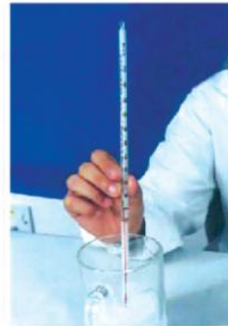
Fig. (2-13) : Utilisation du thermomètre centigrade pour mesurer le degré de température des liquides.
