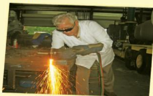
Fig. (3-14) : Le dioxygène mélangé avec l'acétylène est utilisé pour souder les métaux.
