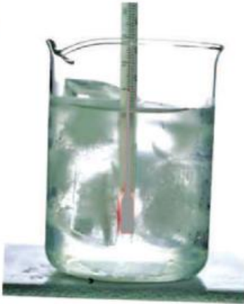
Fig. (2-11) : Le thermomètre centigrade est utilisé pour mesurer le degré de température de l'eau.
