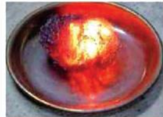
Fig. (3-12) : fil de nettoyage brûlé.
