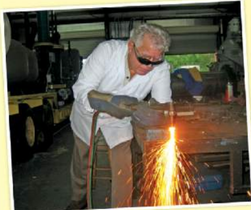
يستخدم الأكسجين مختلطاً مع الأسيثيلين في لحام المعادن.
