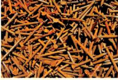
شكل (٣-١١): المسامير يعلوها الصدأ إثر تعرضها للرطوبة.
