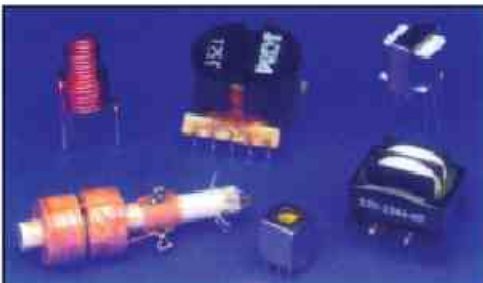
Figure (15-7e) Transformateurs
