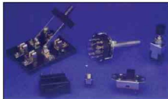
Figure (15-7f) Interrupteurs
