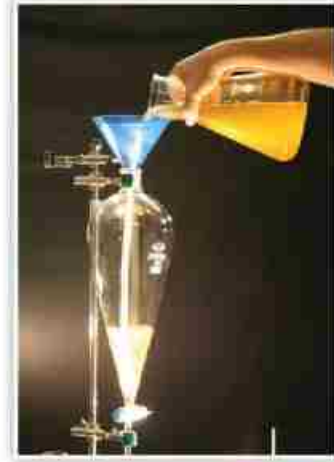
شكل (٣٧): قمع الفصل يستخدم لفصل السوائل غير المتجانسة.
