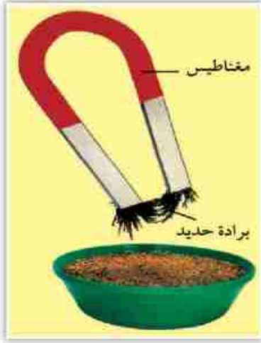
شكل (٣٤): يتم فصل بعض المواد الصلبة المصنوعة من الحديد عن طريق الجذب المغناطيسي.
