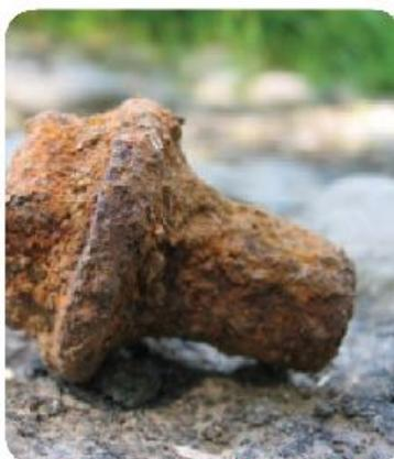
▲ Figure (13) : La rouille du fer réaction chimique lente
