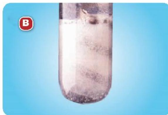
▲ Figure (25) : Réaction du ruban de magnésium avec l'acide chlorhydrique concentré
