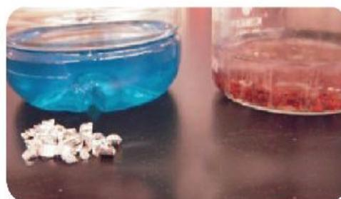
▲ Figure (9) : La substitution d'un métal à la place d'un autre dans la solution d'un de ses sels.
