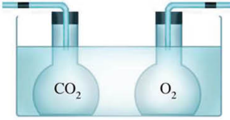
شكل (6) أثر الحرارة في حجم الغاز مع ثبوت الضغط
