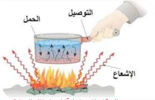
الشكل (2 - 19) آليات انتقال الحرارة
