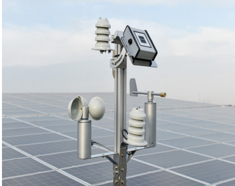
الشكل (2 - 43) محطة الرصد الجوي
