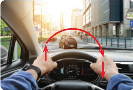
شكل (9) عزم الازدواج على مقود السيارة
