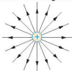
Figure (13) Lignes de forces électriques d'une charge positive
