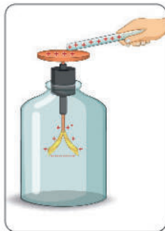
Figure (32) Chargement par contact
