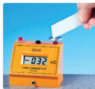
Figure (9) Appareil coulombmètre
