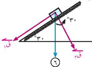
الشكل المقابل يبين وزن الجسم ٦ نيوتن، ويؤثر رأسياً إلى أسفل، مركبة وزن الجسم  $\vec{Q}_1$  تعمل في اتجاه خط أكبر ميل للمستوى ولأسفل، والمركبة الأخرى  $\vec{Q}_2$  وتعمل في الاتجاه العمودي للمستوى ولأسفل.
