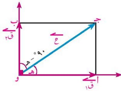
إذا أثرت القوة  $\vec{U}$  في نقطة مادية (و) كما في الشكل المجاور، وكانت مركبتيها المتعامدتين  $\vec{Q}_1$  ،  $\vec{Q}_2$  حيث اتجاه  $\vec{Q}_1$  يميل على اتجاه  $\vec{U}$  بزاوية قياسها  $\theta$  ، فإن متوازى الأضلاع يؤول في هذه الحالة إلى المستطيل  $Q_1Q_2Q_3Q_4$  و، وبتطبيق قانون الجيب على المثلث  $Q_1Q_2W$  فإن:
