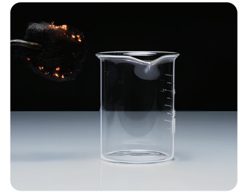
شكل (6) احتراق الصوف الفولاذى فى الهواء الجوى
