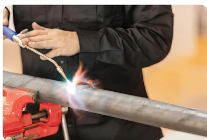
شكل (12) يُستخدم لهب الأكس أسيتيلين في قطع المعادن
